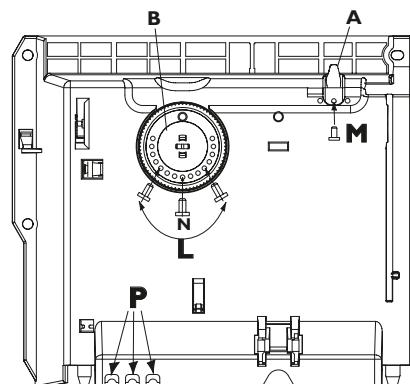
c) Wählen Sie die Position **N**, um den Drehknopf zu blockieren oder die Position **L**, um den Einstellbereich des Drehknopfes zu begrenzen. Wählen Sie eine der Positionen **M**, um den Cursor im gewünschten Modus zu blockieren.
