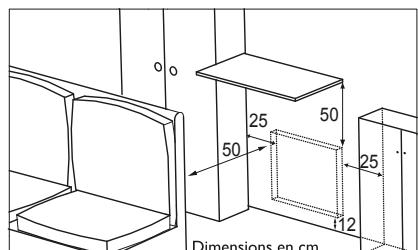
Bij plaatsing van het apparaat moeten de minimale afstanden ten opzichte van andere voorwerpen gerespecteerd worden.
