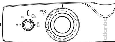
Autre exemple : La molette **D** est positionnée sur 21° C. La température affichée sur votre thermomètre est de 18°C. La valeur d'étalonnage sera donc de -3°C (3 crans).
