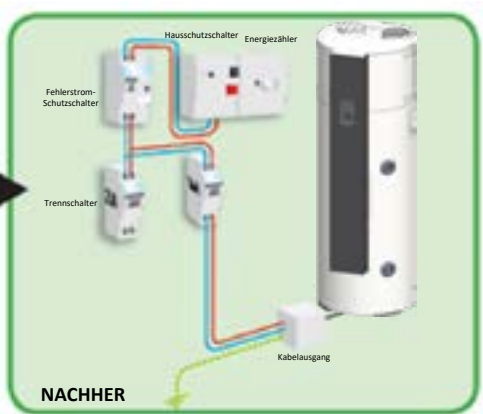
Installation der Warmwasser-Wärmepumpe
