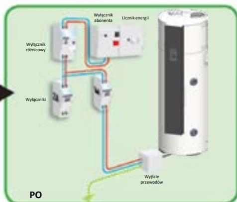
Instalacja pompy ciepła do ciepłej wody użytkowej
