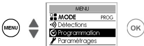
U kunt voor elke dag van de week tot 3 tijdsblokken comforttemperatuur programmeren. Buiten deze tijdsblokken verlaagt het toestel zijn temperatuur (standaard ingesteld op  $-3,5^{\circ}\text{C}$ ). Stel de tijdsblokken in met de toetsen  $\blacktriangle$  of  $\blacktriangledown$  en bevestig met OK.
