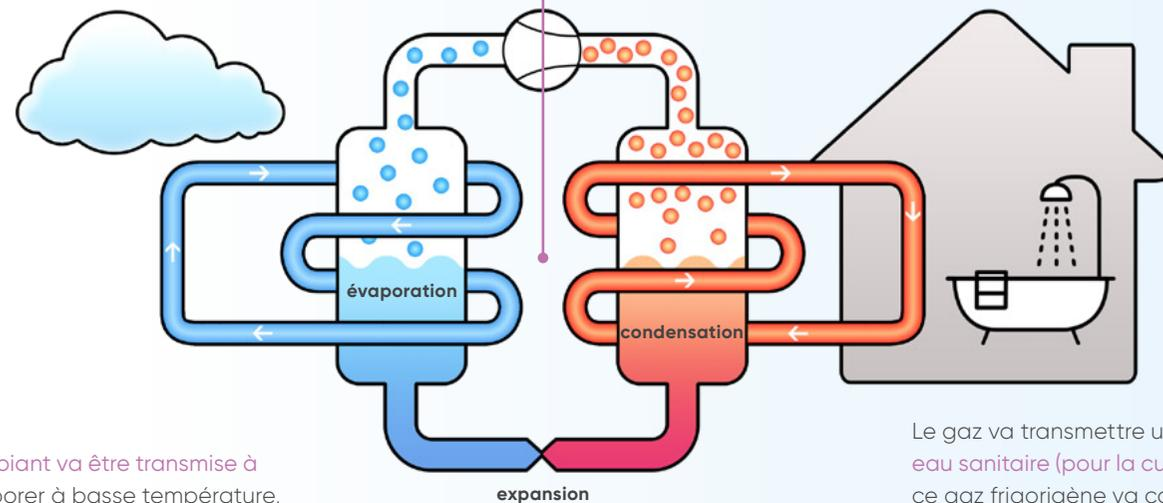
L'énergie thermique récupérée de l'air ambiant va être transmise à un réfrigérant, qui a la propriété de s'évaporer à basse température, avant de continuer sa route.
