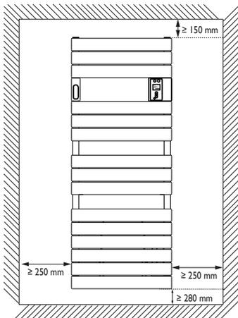
Respectez les distances minimales avec le mobilier pour l'emplacement de l'appareil.
