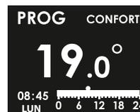
L'appareil fonctionne sur une plage Confort.
