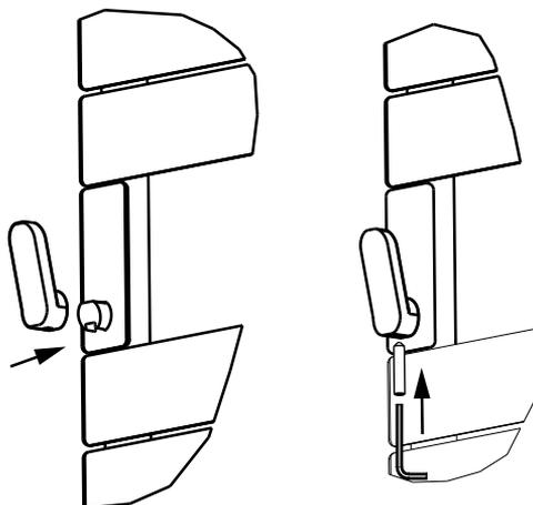
La charge sur le crochet ne doit pas dépasser 10 kgs.
