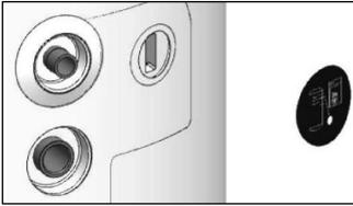
1 Den Magneten aus der Aufnahme neben den Anschlüssen des internen Wärmetauschers herausziehen.
