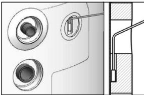
3 Den Fühler in die Öffnung schieben und sicherstellen, dass er bis zum Anschlag in der Aufnahme sitzt.
