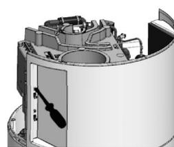
6 Draai de kabelklem op het achterdeksel los om de kabel van de externe uitrusting (niet meegeleverd) erdoor te leiden.
