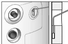
❸ Insérer la sonde dans la goulotte en veillant à ce qu'elle soit bien positionnée au fond du logement.
