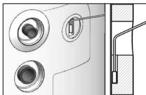
**3** Inserire la sonda nel canale facendo attenzione che sia posizionata correttamente sul fondo dell'alloggiamento.
