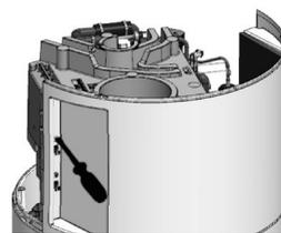
**6** Svitare il serracavo sul coperchio posteriore per farvi passare il cavo (non fornito) delle apparecchiature opzionali.
