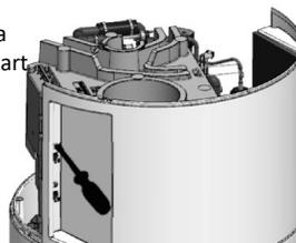
**7** Poprowadzić kabel przez przejście zaprojektowane specjalnie w celu uzyskania dostępu do płytki elektronicznej.
