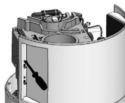
**6** Poluzować zacisk kabla na tylnej osłonie, aby przeprowadzić przez niego kabel opcjonalnego wyposażenia (niedostarczony w zestawie).
