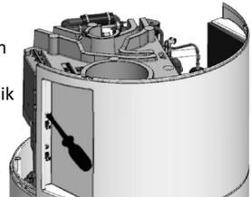
9 Die Kabelklemme verriegeln und die Schritte in umgekehrter Reihenfolge wiederholen, um das Produkt wieder zu schließen.
