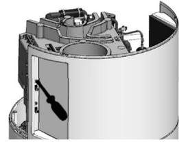
**6** Desserrer le serre-câble sur le capot arrière pour y passer le câble (non fourni) des équipements optionnels.
