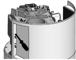
6 Die Kabelklemme an der hinteren Abdeckung lösen, um das Kabel (nicht mitgeliefert) für das optionale Zubehör durchzuziehen.
