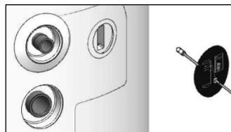
❷ Passer la sonde de température à travers l'aimant (l'aimant a été percé à cet effet).
