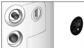
1 Verwijder de magneet uit de behuizing naast de aansluitingen van de interne warmtewisselaar.
