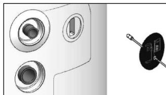
**2** Far passare la sonda di temperatura attraverso il magnete (il magnete è stato forato a tale scopo).
