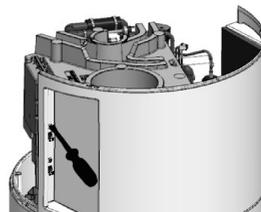
9 Vergrendel de kabelklem en herhaal de stappen in omgekeerde volgorde om het toestel af te sluiten.
