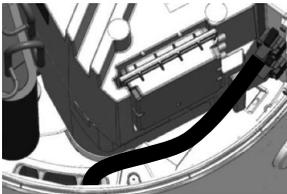
7 Das Kabel durch den speziell vorgesehenen Durchlass führen.
