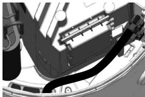
7 Leid de kabel door de opening die speciaal is voorzien voor toegang tot de printplaat.
