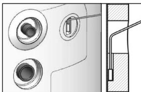
3 Wprowadzić czujnik do kanalika, pamiętając o jego prawidłowym umieszczeniu w głębi gniazda.
