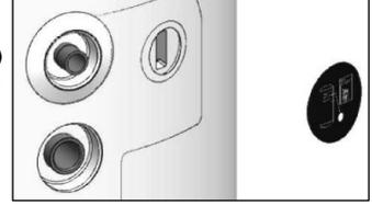
2 مرر مجس درجة الحرارة عبر المغناطيس (تم حفر المغناطيس لهذا الغرض).
