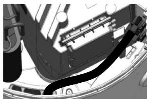
**7** Far passare il cavo attraverso il passaggio appositamente predisposto per l'accesso alla scheda elettronica.
