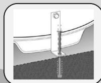
Zamocować ogrzewacz wody za pomocą dostarczonego w zestawie uchwyty mocującego.
