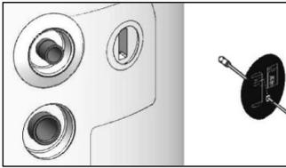
2 Den Temperaturfühler durch den Magneten hindurchstecken (der Magnet besitzt zu diesem Zweck eine Bohrung).
