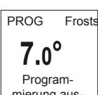
Wenn Sie eine Frostschutztemperatur ( $7^{\circ}\text{C}$ ) eingestellt haben, wird die Programmierung aufgehoben.
