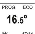
Zeigt der Bildschirm PROG ECO an, befinden Sie sich in einem Programmierbereich des ECO-Modus.
